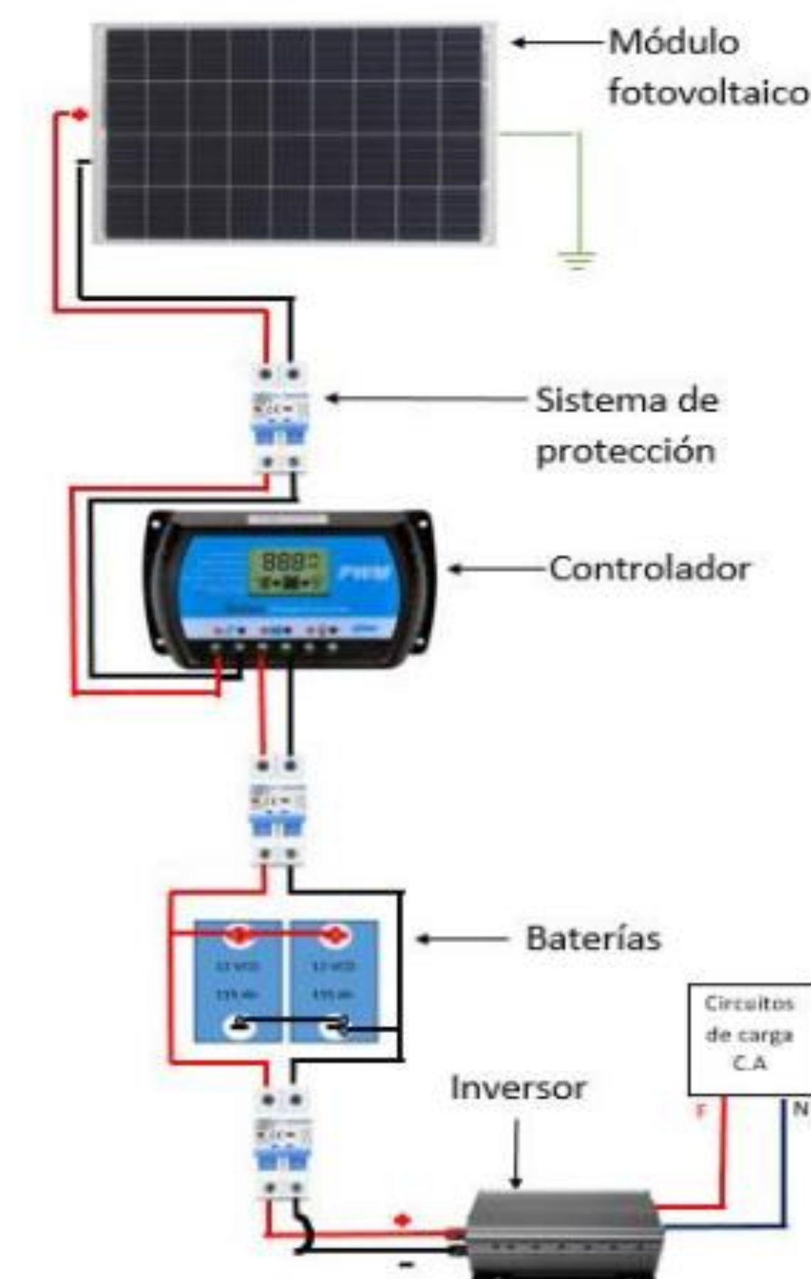
Ilustración 1. Diagrama de conexión del sistema fotovoltaico autónomo.
